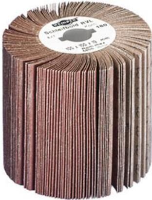
Fächerschleifwalze für den Einsatz auf handgeführten Schleifmaschinen aller handelsüblichen Fabrikate, mit 19-mm-Doppelkeilnuten. Körnungsbereich 40-320.
