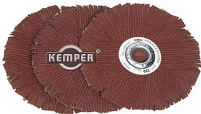
Schleif- und Entgratwerkzeug aus hochflexiblem, geschlitztem Schleifgewebe, Körnungsbereich P 60-800, Fixierung der Lamellen durch stabile Rohrnietung bzw. Kunststoffflansche, Breite je nach Durchmesser und Körnung 5-12 mm.
