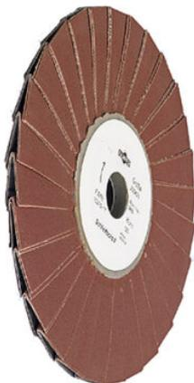
Kehlnahtschleifer für den Einsatz auf stationären Maschinen. Arbeitsfläche ist die Schnittkante des Schleifgewebes, dadurch ansatzfreie Übergänge zur Fläche. Körnungsbereich 40-320.
