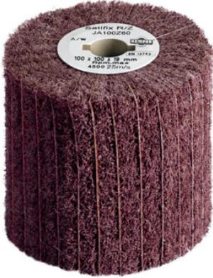
Satinierwalze mit Bohrung 19 mm und zwei Keilnuten 6×2 mm, für nahezu alle Werkstoffe, jedoch besonders für Edelstahl geeignet, kombinierte Ausführung mit Vlies- und Schleifgewebe-Lamellen, dadurch gröberes Schlibbild und höhere Spanabnahme. Vliesqualitäten A 80 (coarse) bis A 280 (very fine), Zwischenlagen P 40 bis P 320.
