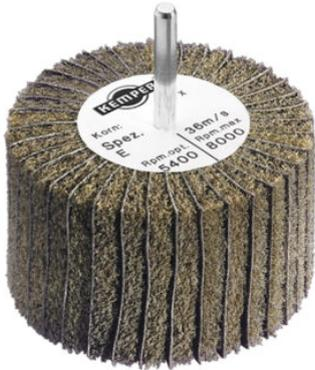
Satinierwerkzeug mit Schaft 6 mm, aus verdichtetem, harten Vlies, kombinierte Ausführung mit abwechselnd eingesetzten Vlies- und Schleifgewebe-Lamellen, dadurch größeres Schliiffbild und erheblich höhere Spanabnahme, für Entgratarbeiten geeignet. Vliesqualitäten A 100 (medium) und A 280 (very fine), Zwischenlagen P 40 bis P 240.
