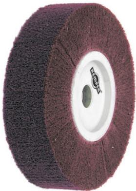
Satinierscheibe mit Standardbohrung 25 mm, Direktmontage auf der Welle, für nahezu alle Werkstoffe, jedoch besonders zur Erzielung feiner, matter Oberflächen auf Edelstahl. Vliesqualitäten A 80 (coarse) bis S 800/1000 (ultra fine).
