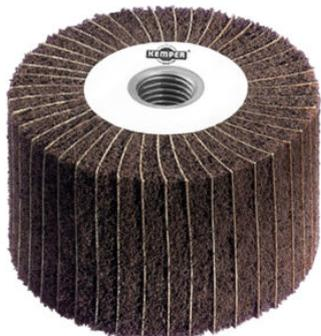
Satinierwalze für den Betrieb auf regelbaren Winkelschleifern, mit Gewebeeinlage. Vliesqualitäten A 80 coarse/P60, A 100 medium/P80, A 180 fine/P150, A 280 very fine/P240.
