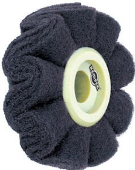
Satinier-Faltring. Der Faltring wird normalerweise zu mehreren Stück nebeneinander als Walze (Montage mittels Seitenflanschen) eingesetzt. Dadurch und durch die Faltung wird ein besonderer, ansatzfreier Schliff auf größeren Breiten erzielt. Vliesqualitäten A 80 (coarse) bis A 280 (very fine) bzw. S100 (medium) – S800 (ultra fine).
